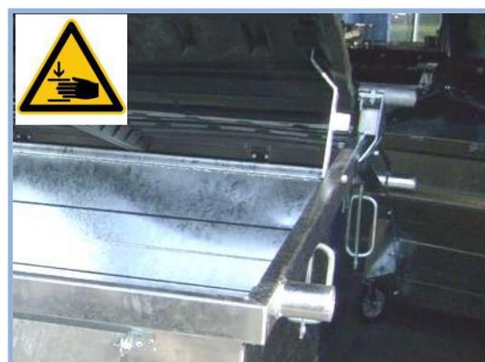
Bei sperrigen Abfällen können jeweils ein oder zwei Deckel einer Behälterseite nach hinten umgelegt werden. Dabei wird, wie vorher beschrieben, der Deckel von vorn angehoben. Die bedienende Person stellt sich an die Seite des Behälters, dabei wird der Deckel durch umfassen permanent gehalten, und fasst den Deckel mit beiden Händen seitlich an und legt den Deckel durch umgreifen der Hände nach hinten um.
