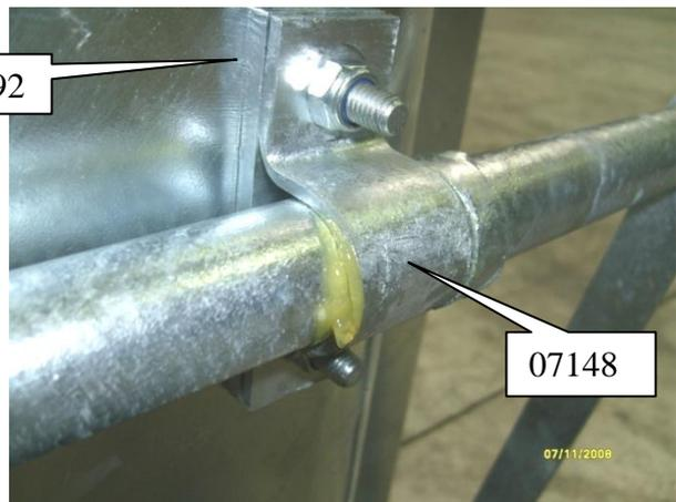
Bei der Montage sollte die Lagerschelle (07148) auf der Innenseite eingefettet werden!
