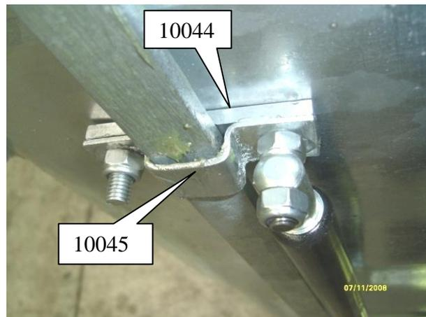
Bei der Montage sollte die Schelle (10045) auf der Innenseite eingefettet werden!
