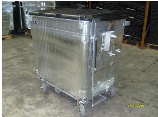
Nach der Positionierung der Führung (10451) muss das Lochbild der Führung auf den Kunststoffdeckel übertragen und mit einem Spiralbohrer  $\varnothing$  6mm gebohrt werden!
