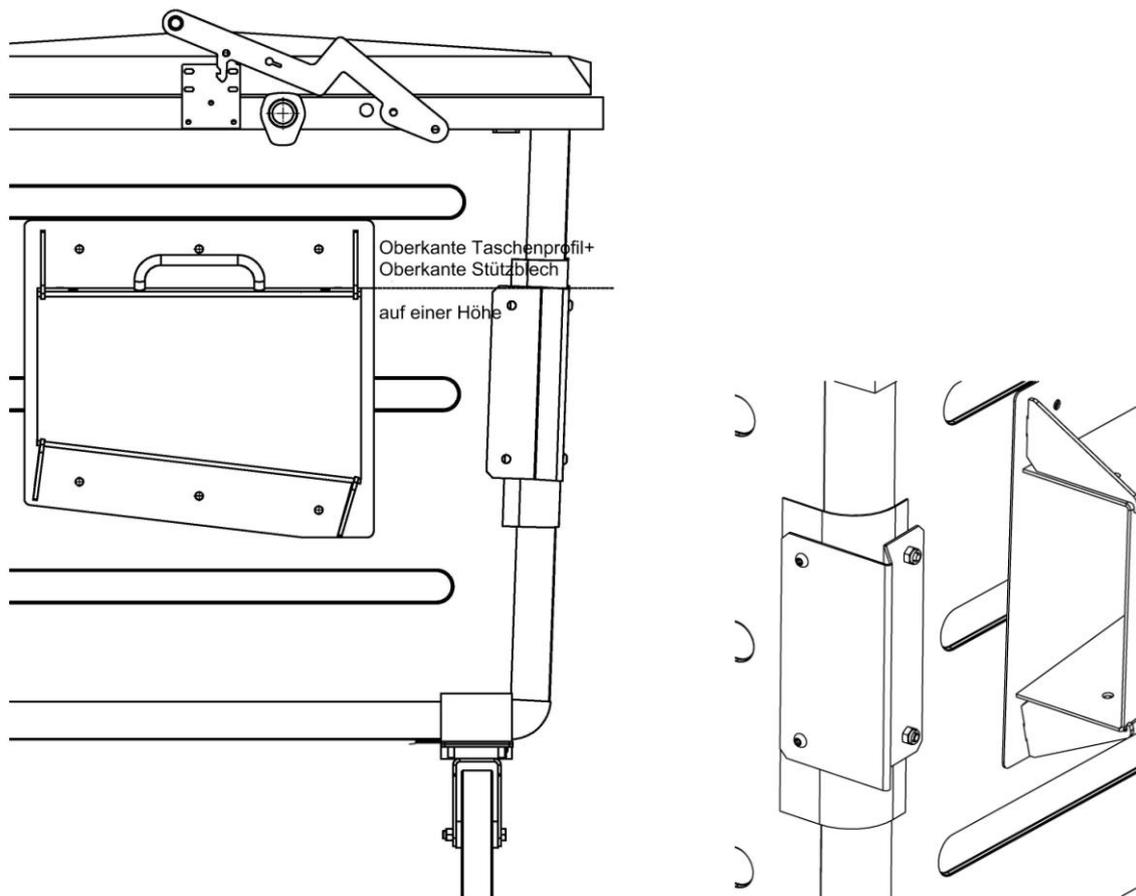
Die Positionierung der Stützbleche erfolgt wie in dem nachfolgendem Bild. Zuerst werden die Bohrlöcher auf der Vorderseite (Vorderwand) angezeichnet und anschließend mittels Bohrmaschine und Spiralbohrer Ø10,5 eingebracht. Danach erfolgt die Montage, die Köpfe der Linsenkopfschraube mit Innensechskant M10x20 sind außen, selbstsichernde Sechskantmutter (M10) innen.
