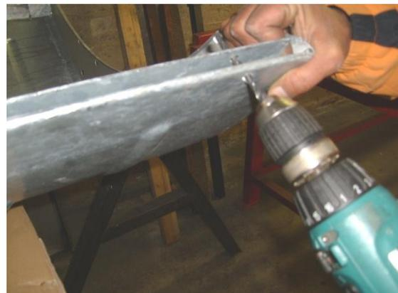
Es ist ggf. erforderlich das Lochbild der Klemmleiste für die Montage am Deckel mittels eines Spiralbohrers Ø 6,2mm nachzubohren!
