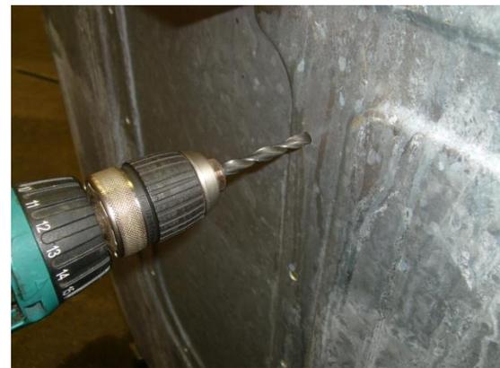
Es ist ggf. erforderlich das Lochbild des Abdeckbleches für die Montage am Rumpf mittels eines Spiralbohrers  $\varnothing$  8,2mm nachzubohren!
