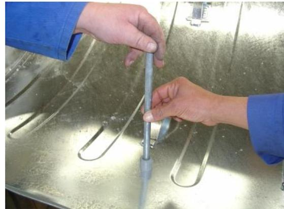
Die Scheibe (G) ist in den Gummipuffer (Y) einzulegen und mittels eines Rohres  $\text{\O}12 \times 2 \times 200$  zu fixieren!
