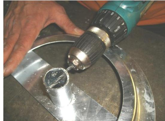
Es ist ggf. erforderlich Zinküberstände an den Rohrstücken mittels einer Feile abzutragen und die Splintlochbohrung am Abdeckblech mittels eines Spiralbohrers  $\varnothing$  6,2mm nachzubohren!
