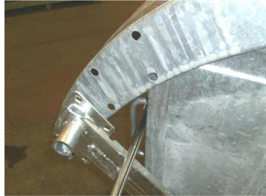
Mittels eines Rohres oder Stange, welche durch die auf der Rückseite befindlichen Griffe geschoben werden, muss eine Fixierung der Deckelarme erfolgen!
