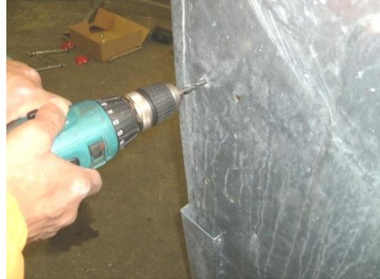
Es ist ggf. erforderlich das Lochbild der Griffe für die Montage am Rumpf mittels eines Spiralbohrers  $\varnothing$  8,2mm nachzubohren!
