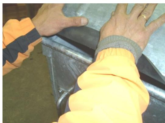
Ist dies nicht der Fall, so sollten die Sechskantmuttern M10 flach (L) leicht gelöst werden und mittels einer Richtkralle und oder Vierkantholz, der Behälterrohrrahmen gerichtet und oder die Position des angeschraubten Schiebedeckels korrigiert werden!
