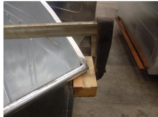
Die dabei zum Einsatz kommende Schraubzwinde muss an der diagonal längeren Weite angesetzt werden, um dem diagonalen Behälterverzug entgegenzuwirken!
