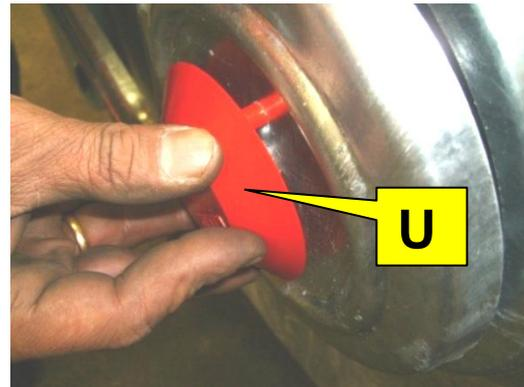
Es ist ggf. erforderlich das Lochbild der Abdeckkappe (U) für die Montage am Deckelarm mittels eines Spiralbohrers Ø 8,0mm nachzubohren!
